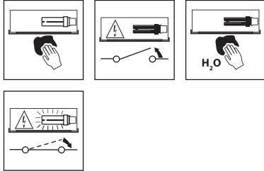
**IT** Pulire regolarmente il vetro/diffusore del proiettore, utilizzando un panno morbido. - Non utilizzare sostanze chimiche per pulire il vetro/diffusore del proiettore.
